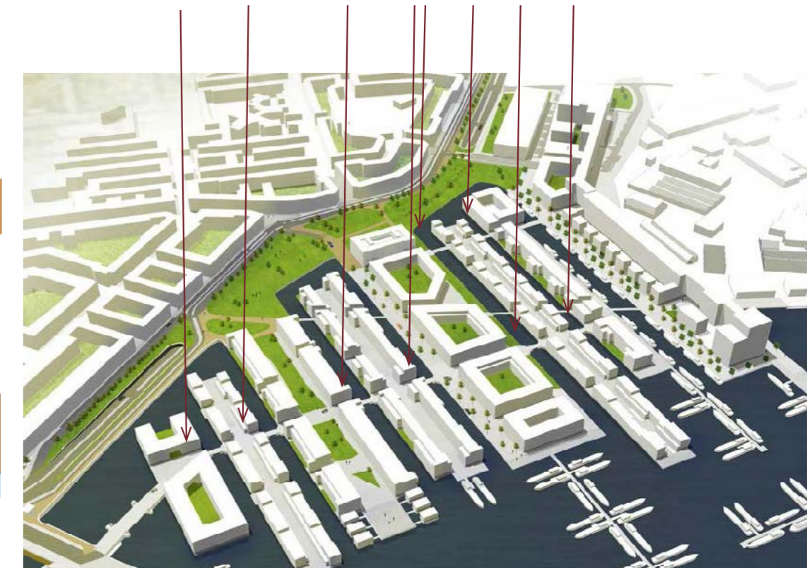
Brugtype A1: 8 verkeersbruggen met overspanning van 18 meter, breedte 6,75 meter, doorvaartprofiel 1,90 x 5,00 meter
